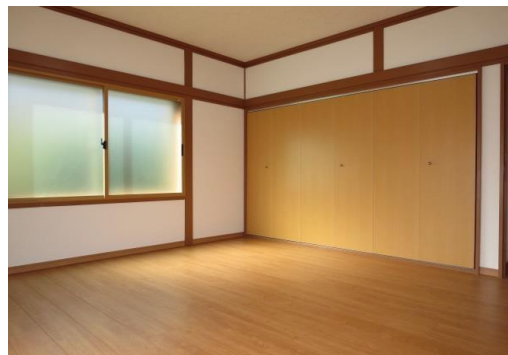
和室の続き間に壁を設け、畳をフローリングに貼り換えることで現代風の生活がしやすい洋間に変更。元のサッシを活かすことでコストは抑制(青森県)
